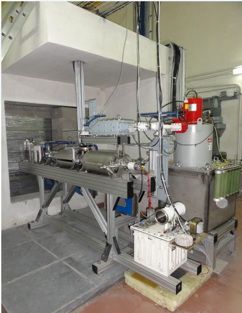
Линейный ускоритель УЭЛР-8-10А (LINAC, 8 MeV, 10 kW)
